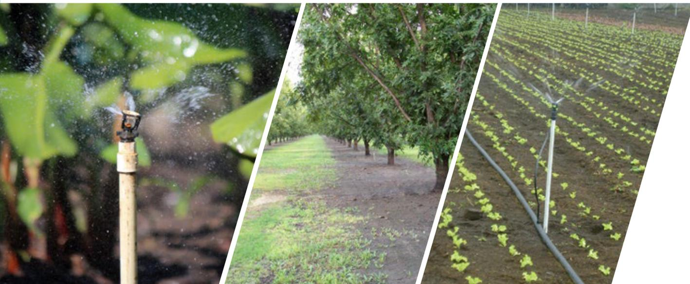
El aspersor **Mini Wobbler** actúa mediante la rotación de un deflector ranurado combinada con una acción oscilante. Los aspersores **Mini Wobbler** distribuyen gotas de lluvia, con menor intensidad de aplicación sobre una mayor área de cobertura a bajas presiones. Esto ayuda a reducir la compactación del suelo y la escorrentía superficial.
